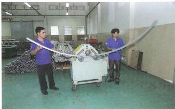
Máy uốn vòng cung ARE Bending Machine
