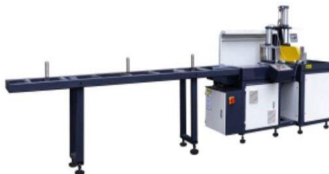
Máy cưa và cắt tự động một đầu KT 323DA
