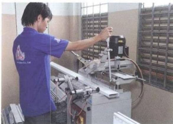
Máy phay ngón Ending milling machine
