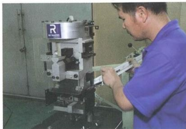
Máy dập ngàm dập lỗ Punch unit drainage
