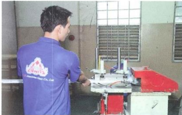
Máy phay ngàm Spindles copy milling
