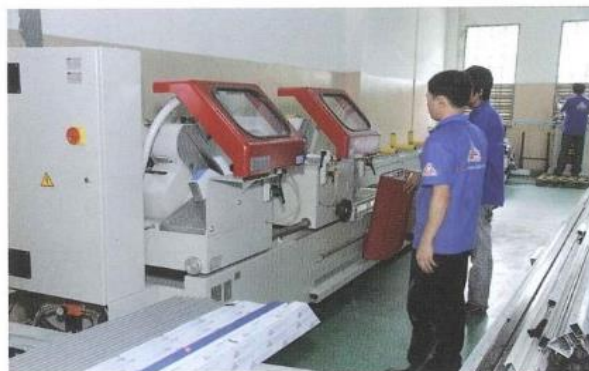
Máy cắt hai đầu đa năng Semi-automatic double head cutting machine
