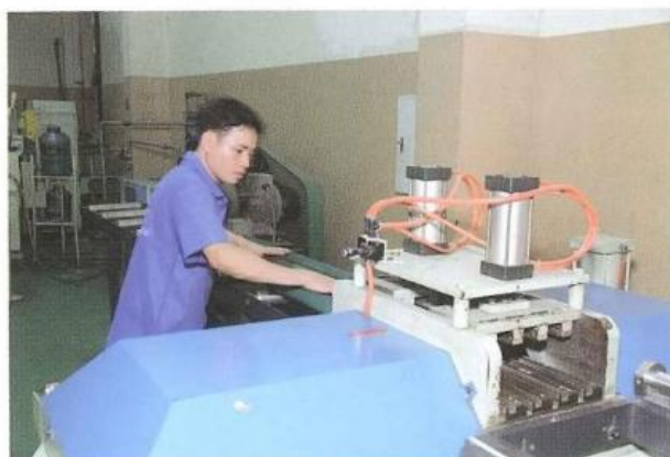
Máy chuyên dùng cắt 45° 45 cutting machine
