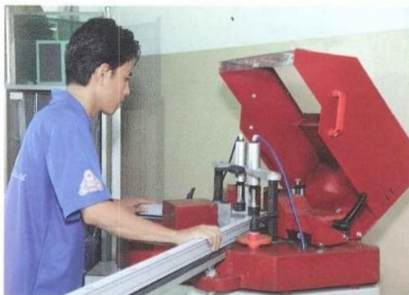
Máy ép góc thể hệ mới Pneumatic corner crimping machine
