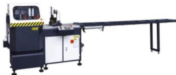
Máy cưa một đầu tự động KT 328A
